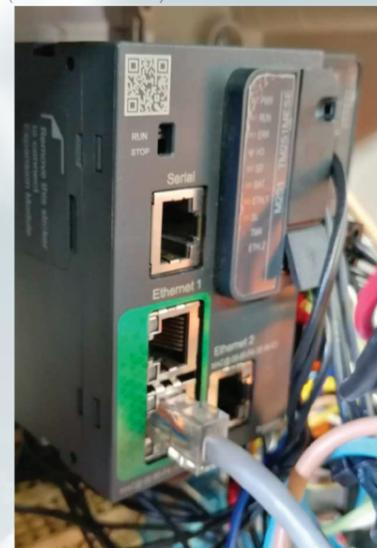
Il suddetto **PLC** è in grado di fornire una molteplicità di informazioni che possono essere visualizzate sul pannello di controllo di ultima generazione mod. **MAGELIS SCHNEIDER LCD touch da 7,5”**, (vedi foto 2)
