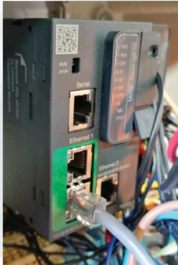
Il suddetto **PLC** è in grado di fornire una molteplicità di informazioni che possono essere visualizzate sul pannello di controllo di ultima generazione mod. **MAGELIS SCHNEIDER LCD touch da 7,5”**, (vedi foto 2)
